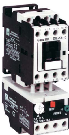
DIL-K...+H0-2K demaror cu protecție termică pentru motoare
